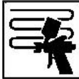
**Important :** Maintenir la pression basse à 1.5 bar pour éviter une formation excessive de brouillard durant la retouche. Abaisser la pression à 0.5 bar durant le dégradé.
